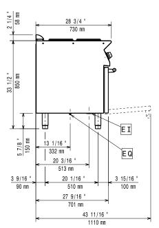
Electrical inlet (power) Equipotential screw
